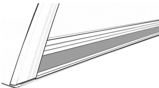
Закрываем монтажный паз в нижнем профиле, с помощью уплотнителя.
