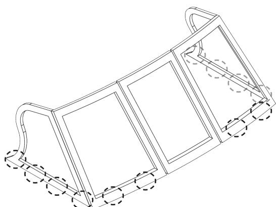
Затем в отмеченных ранее точках, с помощью сверла 4,8 мм в палубе лодки просверливаем отверстия и фиксируем рамку к корпусу лодки винтами M4x40
