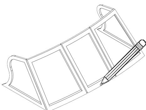
Для дальнейшего, точного, позиционирования ветрового стекла относительно оси симметрии лодки. Так же необходимо отметить центр палубы в районе выхода (калитки).
