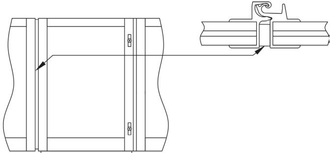
Наклеиваем уплотнитель 6х12 в проём калитки.
