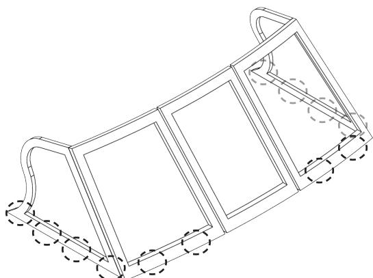
Устанавливаем рамку на место и фиксируем ее на лодке винтами через подготовленные ранее отверстия.
