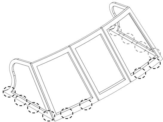
В нижнем профиле рамки есть отверстия, через которые будет осуществляться крепление ветрового стекла к корпусу лодки. В случае если по какой-то причине вы не можете использовать данные отверстия, необходимо самостоятельно просверлить профиль рамки в ближайшем доступном месте используя для этого сверло диаметром 4,8-5 мм.
