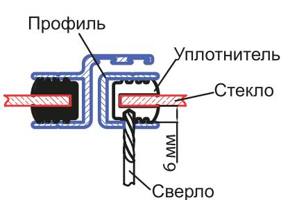
Сверловка бокового профиля для крепления упорных стоек.
