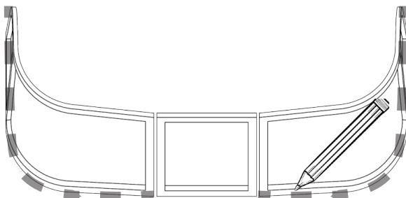
Очерчиваем контур рамки карандашом для наклеивания уплотнителя (под рамку) с клеевой основой.
