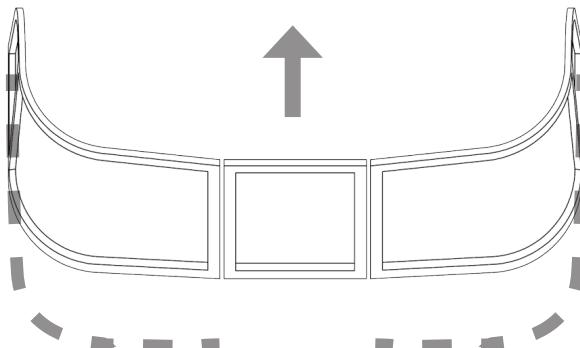
7.1 Откручиваем рамку от палубы лодки и снимаем её.
